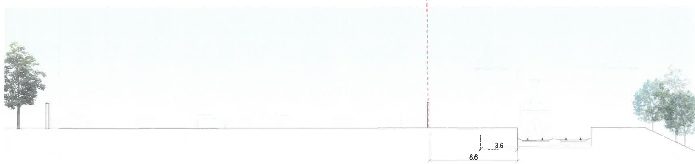
parking relais en ouvrage semi-enterré, H=L (Hauteur du parking = Longueur entre la limite séparative et le parking) – dérogation au PLU sur la zone (PLU: 5m de prospect)
